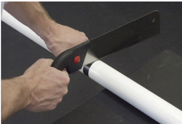
Acima: Um serrote de dentes finos facilita o corte do tubo.
