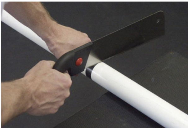
Arriba: Una sierra de arco de dientes finos facilita cortar el tubo.
