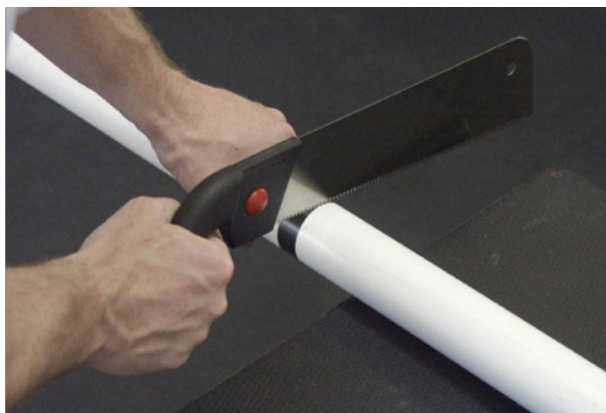
Ci-dessus : une scie à métaux à dents fines facilite la coupe du tuyau.
